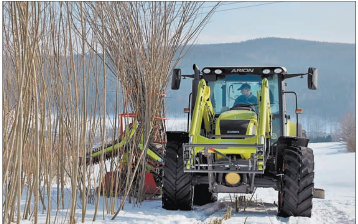
Der Prototyp des neu entwickelten Rutenernters schneidet die 2 bis 3 m hohen Schösslinge schonend und sammelt sie vertikal zu Bündeln. Bild unten: Kerstin und Thomas Böhme sind sich einig, dass bei der Schneedecke die Ernte der Schösslinge im Mutterquartier noch warten muss.
