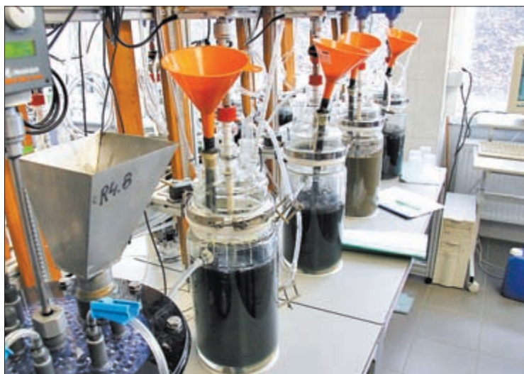
Im Biogaslabor prüfen die Forscher die Wirkung von Spurenelementen auf die Gasausbeute.
